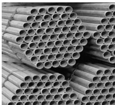
Σχήμα 5.4: Οι σωληνώσεις από γαλβανισμένο σιδηροσωλήνα βαρέως τύπου (Πηγή: http://www.sidma.gr/ ).
