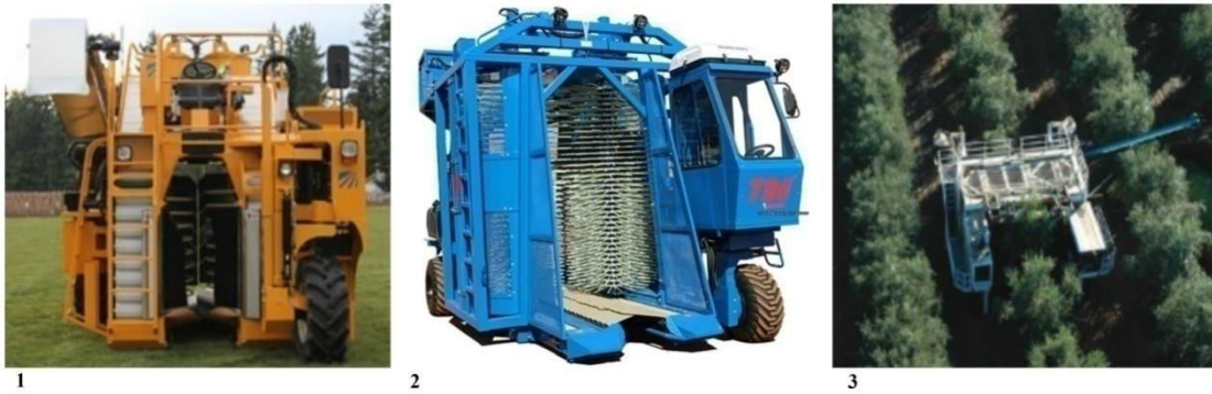
Εικόνα 3.7.1. Ελαιοσυλλέκτες 1) Παραλλαγή συλλέκτη σταφυλιού 2) Παραλλαγή συλλέκτη καφέ 3) Ελαιοσυλλέκτης γραμμής
