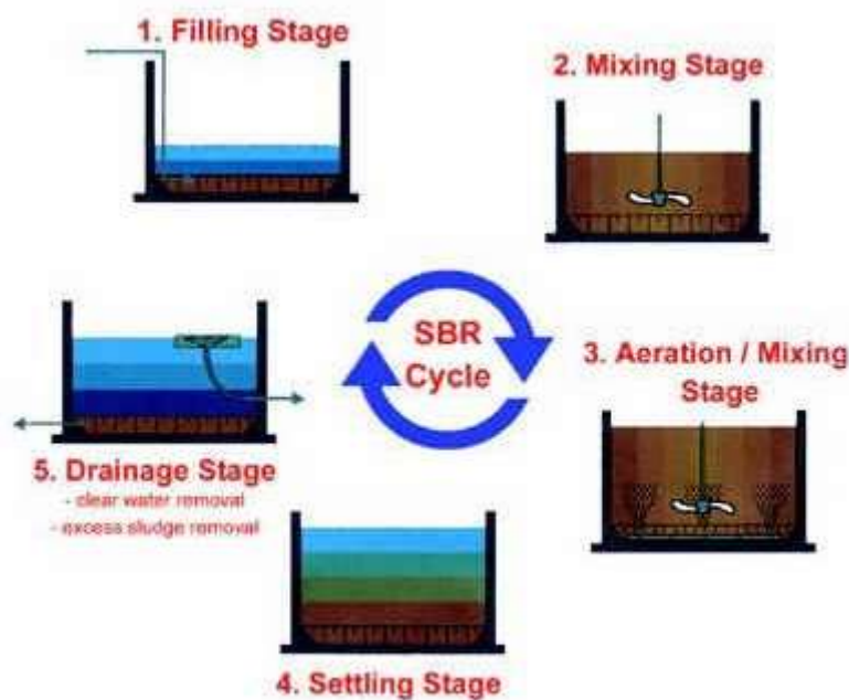
Εικόνα 11: Κύκλος λειτουργίας της τεχνολογίας SBR (πηγή: http://www.thewatertreatments.com ).
