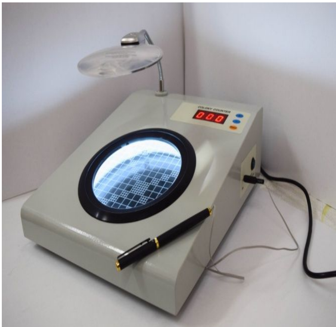
Εικόνα 4 COLONYCOYNTER : μηχανήμα μέτρησης αποικιών
