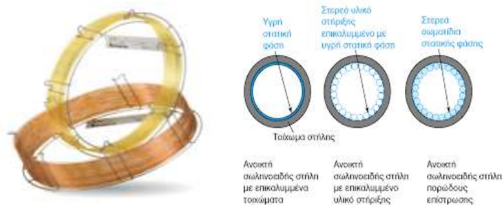
Εικόνα 3.2 Αριστερά: εξωτερική μορφή στήλης. Δεξιά: διατομές τριών ειδών τριχοειδούς στήλης
