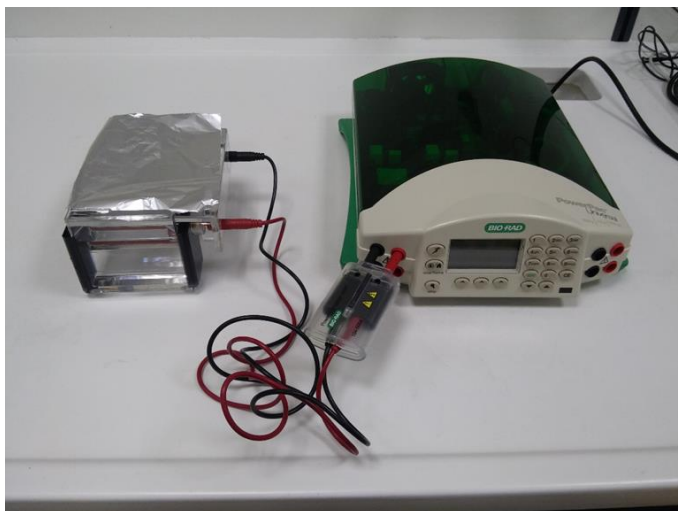
Εικόνα 1.4 : Συσκευή ηλεκτροφόρησης πρωτεϊνών.
