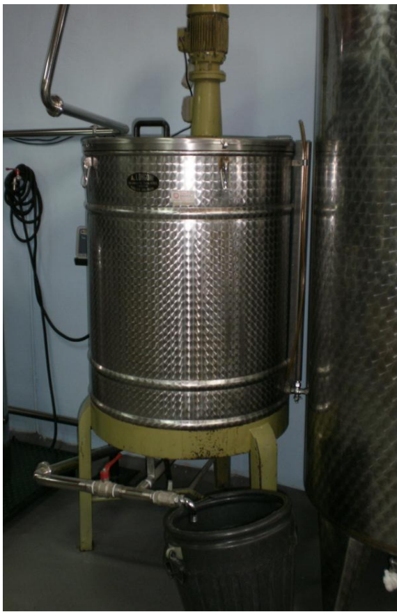
Εικόνα 1: Δεξαμενή αποστάγματος (Πηγή: Κωστέας)
