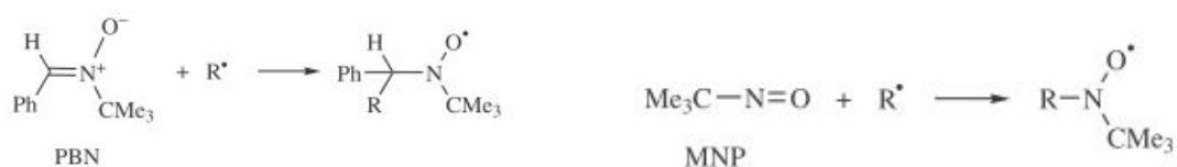
Σχήμα 4.5. : Σχηματισμός ρίζας νιτροξυλίου.
