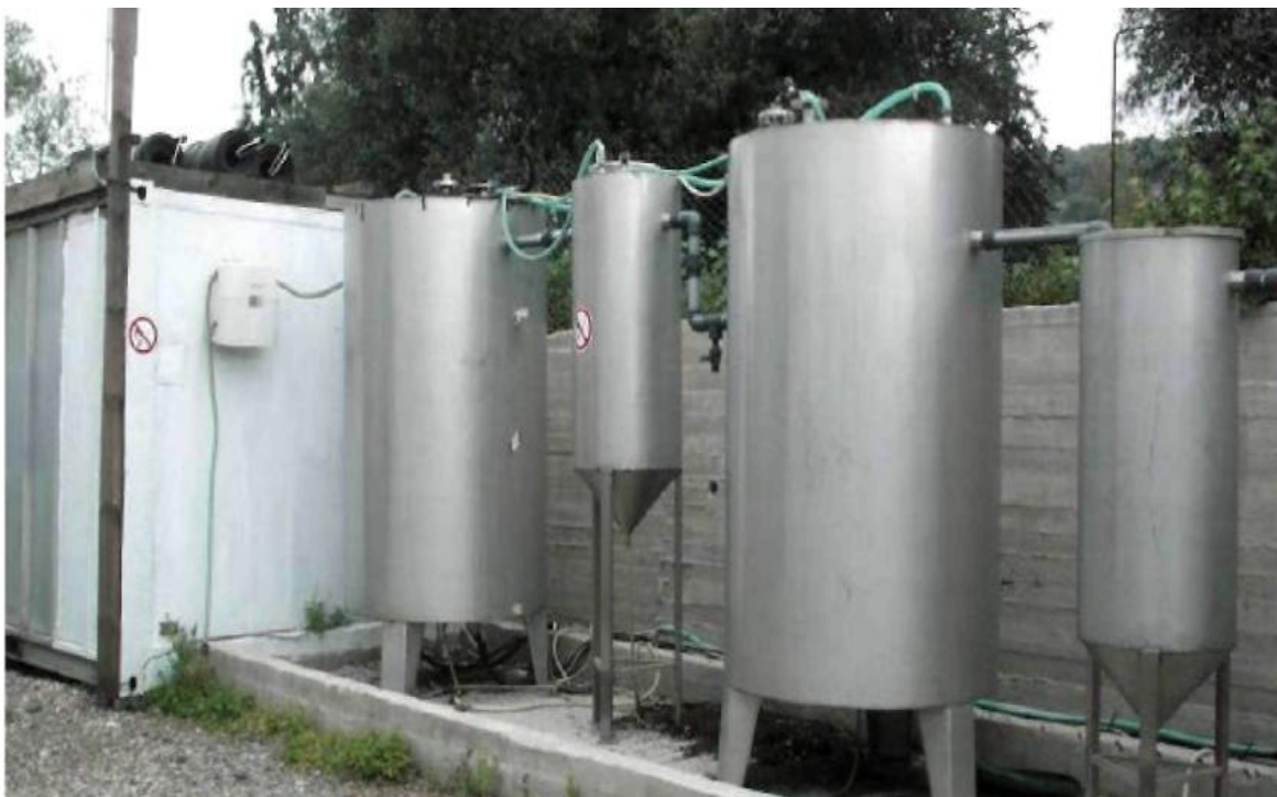
Εικόνα 6.2.9.1 Πιλοτική μονάδα αναερόβιας επεξεργασίας κατσίγαρου (Βαμβακόπουλο Χανιών, Κρήτη) (Καλογεράκης και Νικολαΐδης, 2008)
