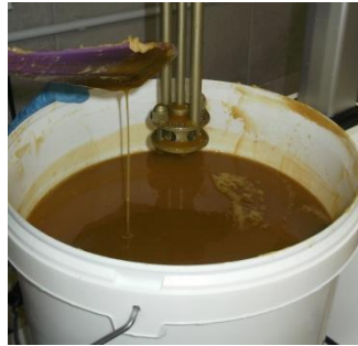
Εικόνα 13 – Ανάμειξη πρώτων υλών και διαλύματος NaOH
