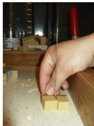
Εικόνα 15 – Κόφτης με τη χρήση χορδής
