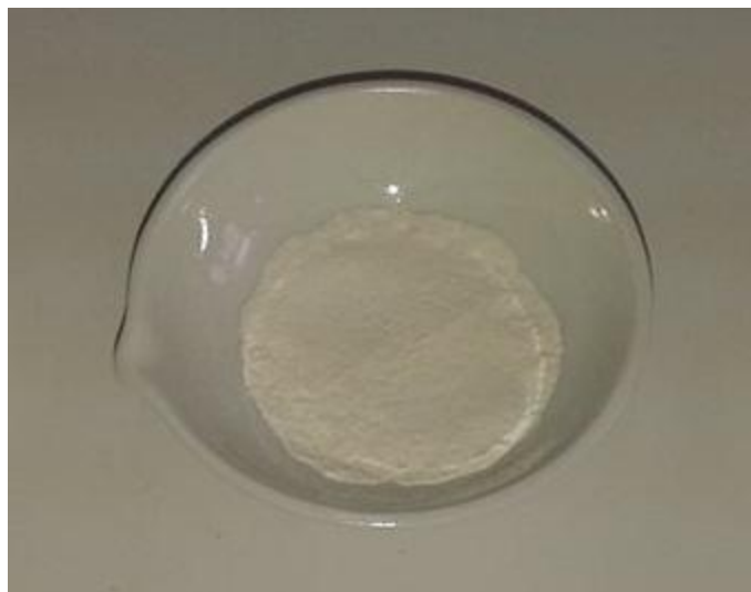
Εικόνα 11: Η κάβα πορσελάνης στην οποία ζυγίζεται και ξηραίνεται σε κλίβανο το αλεύρι.
