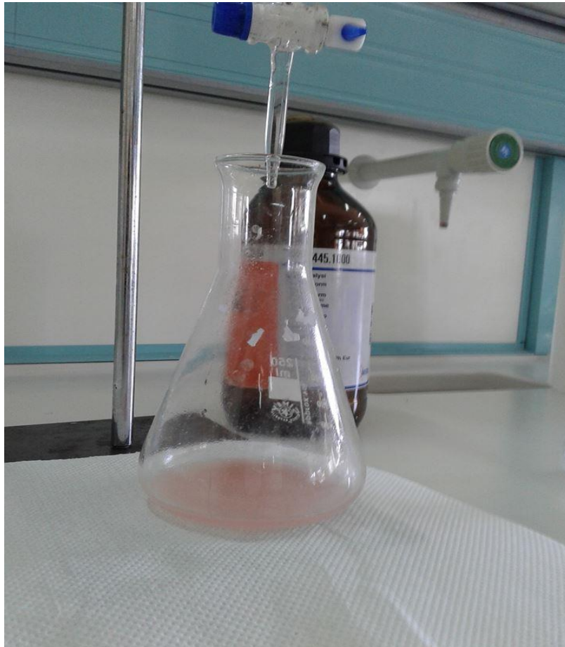
Εικόνα 10: Η τιτλοδότηση του δείγματος με KOH 0.02 N τελειώνει όταν το δείγμα πάρει αυτήν την ανοιχτή ροζ απόχρωση.
