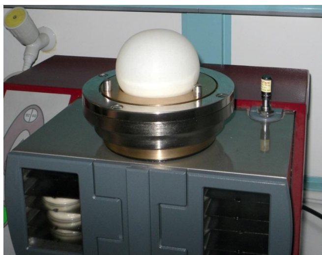
Εικόνα 18: Η ζύμη κατά τη διάρκεια της διοχέτευσης αέρα στο τμήμα διόγκωσης του αλβεογράφου. Διακρίνεται και ο θάλαμος σταθερής θερμοκρασίας στον οποίο αφήνονται τα δισκία ζυμαριού για 20 min.
