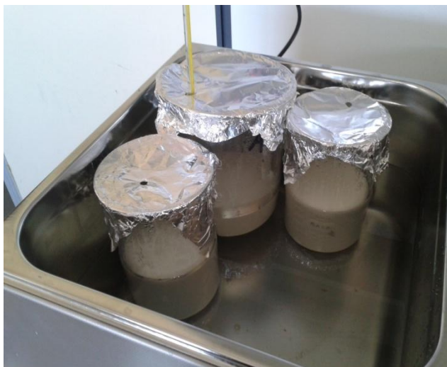
Εικόνα 4: Μέτρηση θερμοκρασίας του δείγματος κατά τη διάρκεια του υδατόλουτρου
