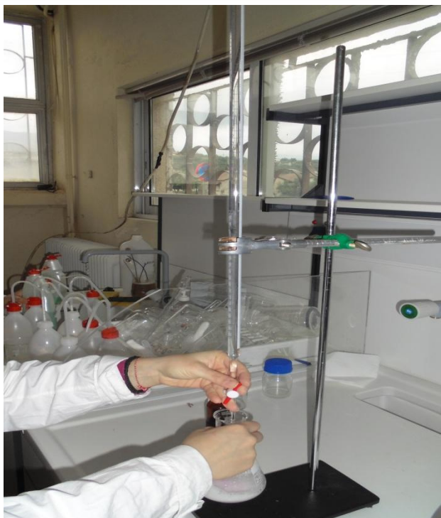
Εικόνα 5: Μέτρηση οξύτητας, με τη μέθοδο της ογκομέτρησης
