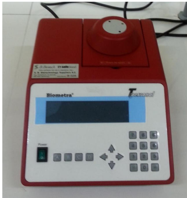
Σχήμα 1.3: Θερμικός κυκλοποιητής (thermal cycler).
