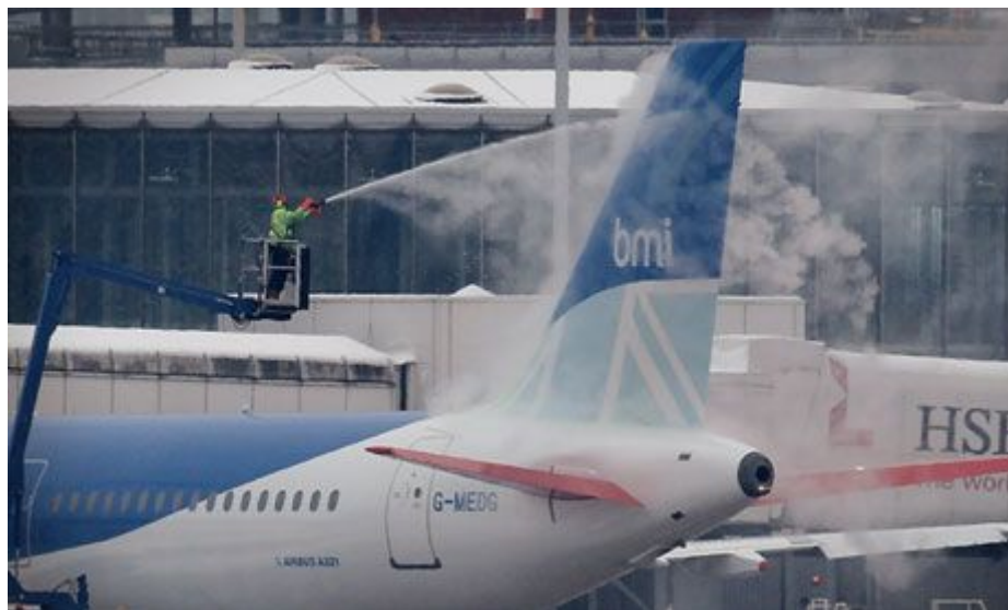
Σχήμα 31: Διαδικασία αποπάγωσης αεροσκάφους πριν την αναχώρηση
