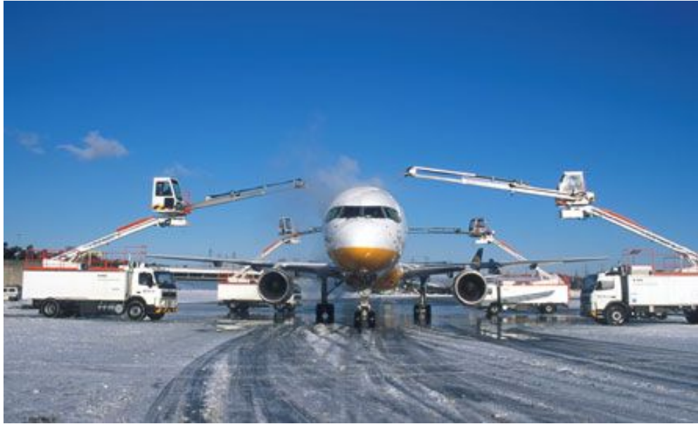
Σχήμα 30: Διαδικασία αποπάγωσης αεροσκάφους πριν την αναχώρηση
