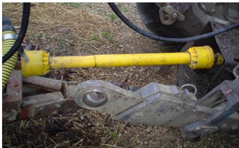
Εικόνα 6. Προστατευτικός βραχίονας που καλύπτει τον άξονα περιστροφής
