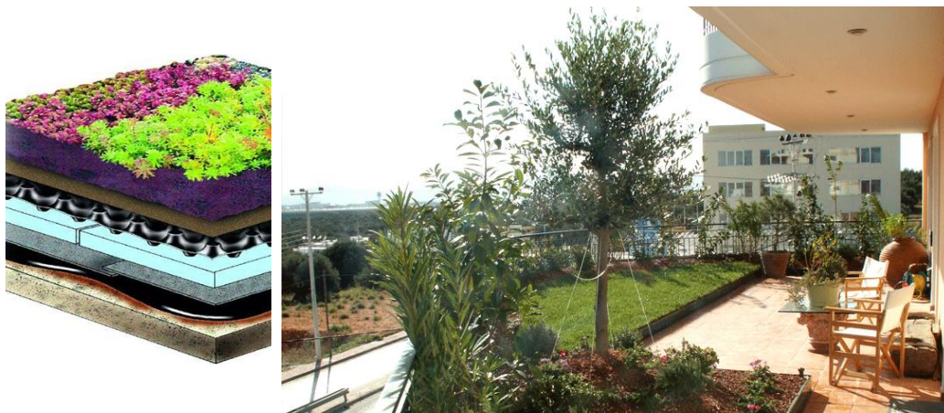
Εικόνα 1.2: Χρήση του πετροβάμβακα στην Αρχιτεκτονική τοπίου για την κατασκευή πρασίνου σε ταράτσες κτιρίων (πηγή: Διαδίκτυο 15)
