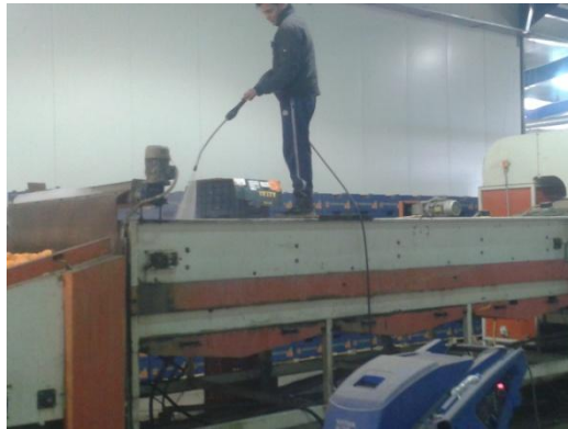
Εικόνα 9 Πλύσιμο. Βρέξιμο- Σαπούνισμα- Πλύσιμο- Παροχή μκητοκτόνων
