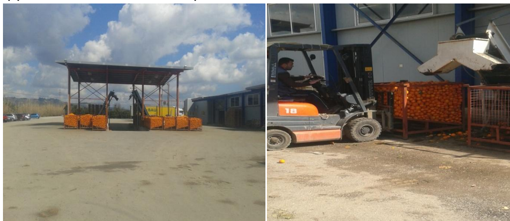
Εικόνα 6 ΤΟ ΕΚΦΟΡΤΩΜΕΝΟ ΠΡΟΙΟΝ ΠΕΡΝΑΕΙ ΑΠΟ ΤΟ ΧΩΝΙ & ΧΩΡΙΖΕΤΑΙ ΣΕ ΧΥΜΟΠΟΙΗΣΙΜΟ & ΠΡΟΣ ΕΠΕΞΕΡΓΑΣΙΑ
