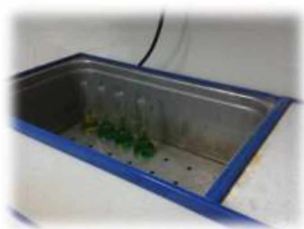
Εικόνα 3.2 Συσκευή υδατόλουτρου που χρησιμοποιήθηκε για την προετοιμασία των δειγμάτων φυτικών ιστών.
