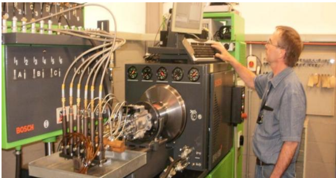
Εικ 3.8 Τοποθέτηση της αντλίας στην τράπεζα δοκιμών.
