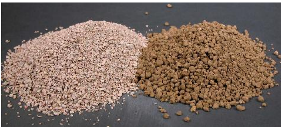
Εικόνα 4.4: Δυο παραδείγματα προϊόντων σκληρής αργίλου. Αριστερά, turface και δεξιά akadama (πηγή Randy Clark Charlotte, Guidelines For Creating Bonsai Soil).
