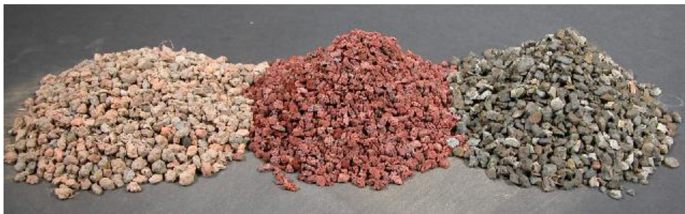
Εικόνα 4.5: Τρία παραδείγματα πορώδους αδρανούς υλικού, Haydite (πηγή Randy Clark Charlotte, Guidelines For Creating Bonsai Soil).
