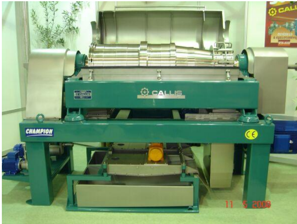
Εικόνα 14: Φυγοκεντρικός ελαιοδιαχωριστήρας (Decanter) (Πηγή: www.elia-diktyo.gr )
