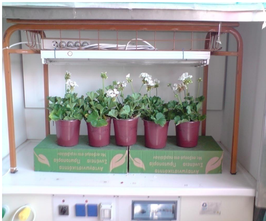
Εικόνα 5.1: Τα φυτά τοποθετημένα στο θάλαμο ακτινοβολήσης κάτω από τις λάμπες UV-C ακριβώς πριν τη στιγμή της ακτινοβολήσης
