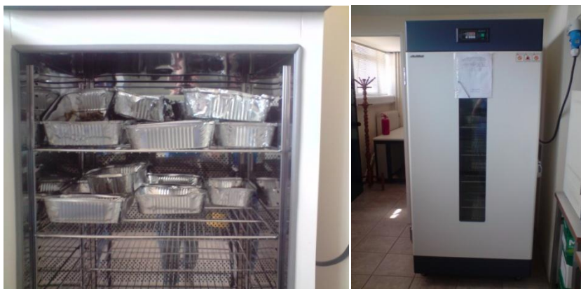
Εικόνα 5.2: Το εσωτερικό του ξηραντήρα εφόσον έχουν τοποθετηθεί κάποια δισκάκια με φυτά και το εξωτερικό του
