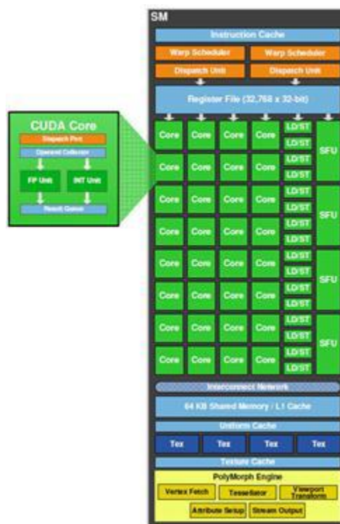
Εικόνα 16: Εικόνα 16: Streaming Multiprocessor της GPU.
