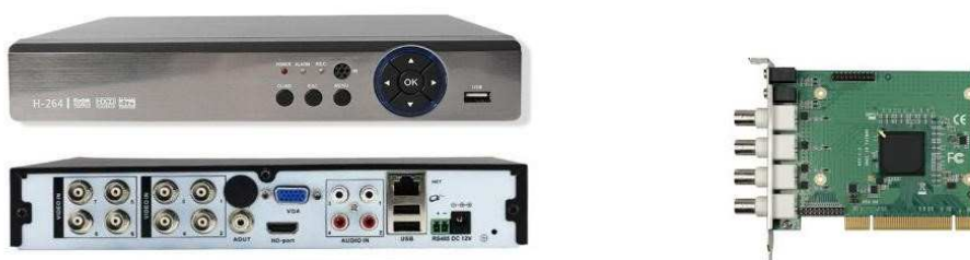
Εικόνα 2.2 – Standalone DVR και board DVR
