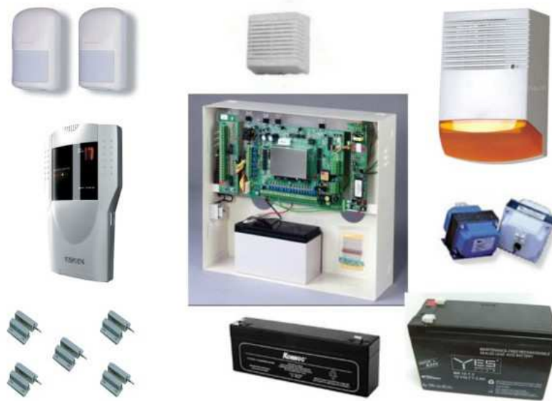
Εικόνα 3.1 – Τα βασικά μέρη ενός συστήματος συναγερμού για οικιακή χρήση
