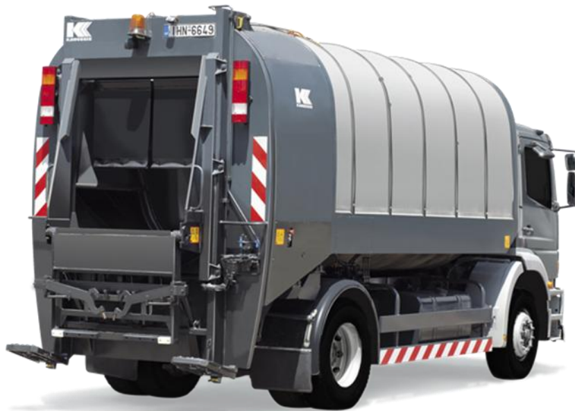
Εικόνα 1.1 Όχημα μεταφόρτωσης απορριμμάτων
