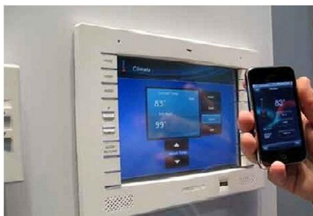
Εικόνα 9. Σύστημα διαχείρισης πολυμέσων οικίας, που συνδέεται και με κινητό τηλέφωνο για απομακρυσμένη διαχείριση.
